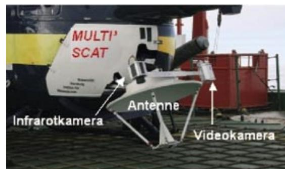
Radarantenne, Infrarot- und Videokamera des Multi3Scat.
